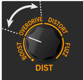
Réglage du modèle overdrive de la catégorie distorsion
